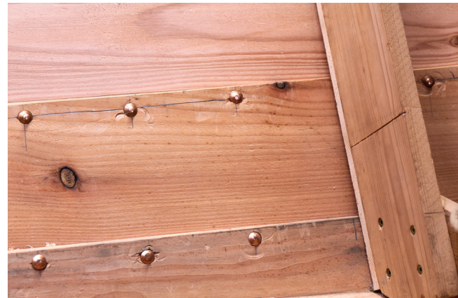
Klinkbyggede planker og et enkelt spant set om bord fra en jolle under bygning i Struer. Plankerne overlapper hinanden og er samlet med kobbersøm. Foto: Søren Stidsholt Nielsen
