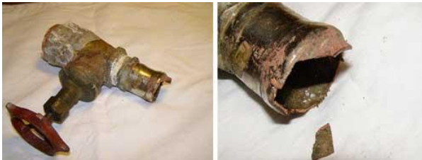
Bronzeventil med messingstuds (metaller man aldrig må blande). Studsen tærer væk!
