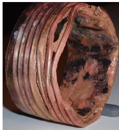
Denne studs er fra båden omtalt i artiklen i: "En sejlers mareridt", se menuen. Læg mærke til at al zinken i messing er tæret væk, så resten er "sprødt som knækbrød".
